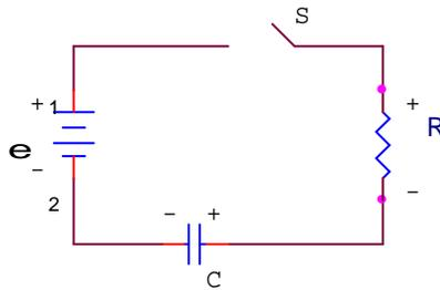
Figura2. Circuito para carregar capacitor.
