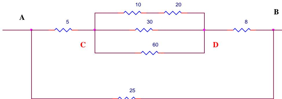
*Solução:* Colocam-se as letras C e D nos nós da associação. Entre eles, os resistores de  $10\ \Omega$  e  $20\ \Omega$  estão associados em série. A resistência equivalente entre eles é
