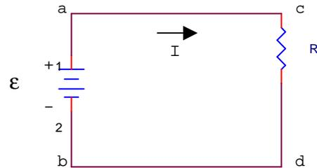
Numa **bateria real**, a diferença entre os terminais, a **voltagem da bateria**, não é igual a fem. Se fossemos colocar uma bateria real no circuito acima perceberíamos que se a corrente variar pela variação de **R**, e se medirmos a voltagem da bateria verificaremos que a voltagem diminui quando a corrente aumenta. É como se a bateria real fosse constituída da bateria ideal de fem  $\varepsilon$ , mais uma pequena resistência **r**, a **resistência interna**.
