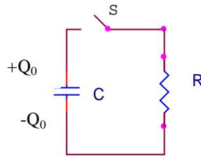
Figura1. Capacitor em série com uma chave (S) e um resistor R.
